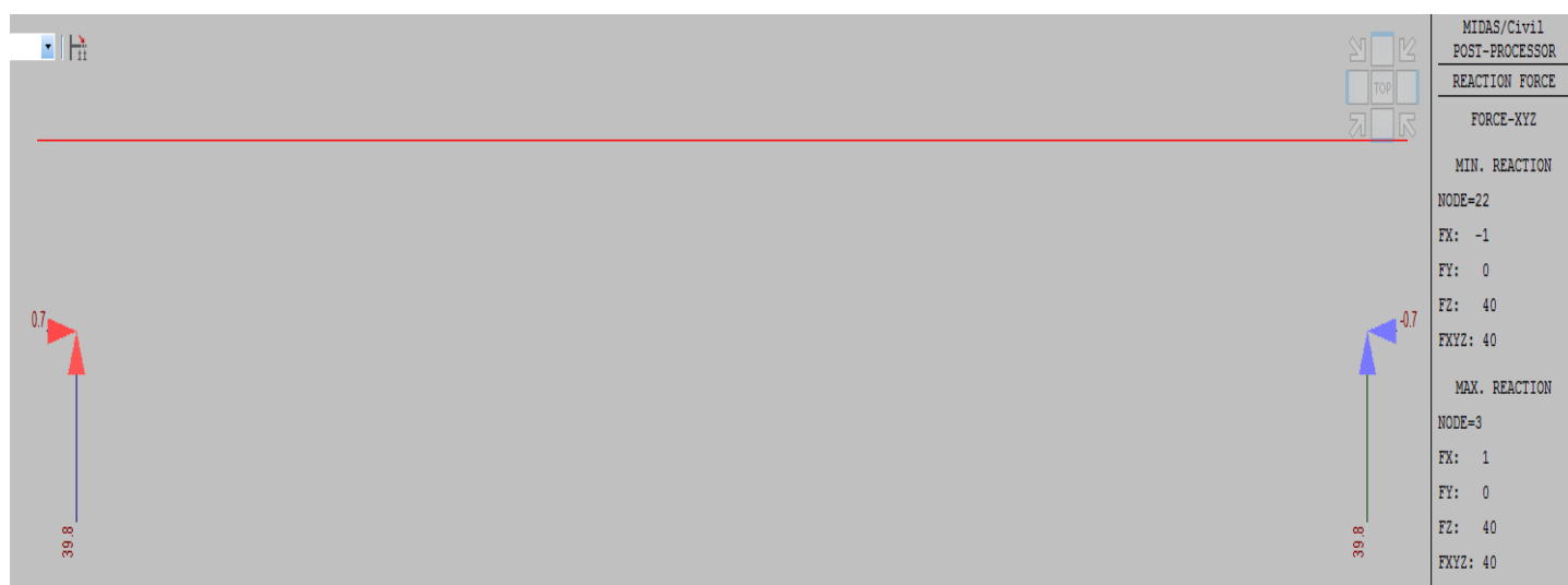
Figura 22 – G3: Reações R_x e R_z (valores em tf: R_{x.esq} = -R_{x.dir} = 0,7tf e R_{z.esq} = R_{z.dir} = 39,8tf )
