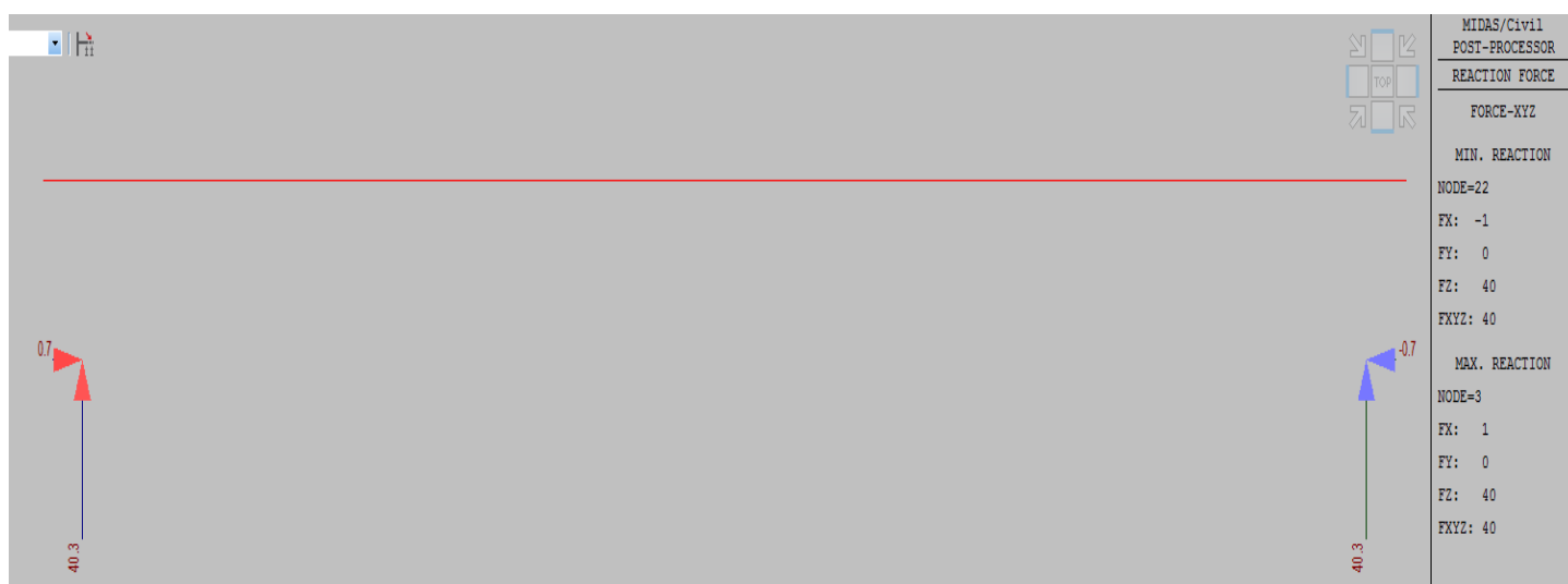
Figura 16 – G2: Reações R_x e R_z (valores em tf: R_{x.esq} = -R_{x.dir} = 0,7tf e R_{z.esq} = R_{z.dir} = 40,3tf )
